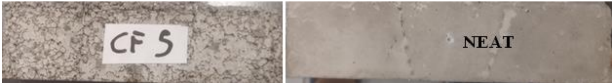
Figura 3: Cementi caricati con le fibre di carbonio ottenute dallo scarto della produzione di TNT riciclati
